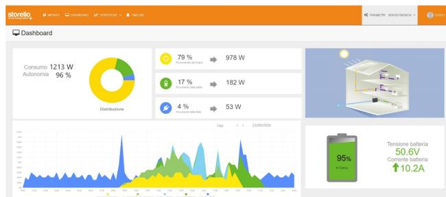
**storelio®** è un sistema di accumulo lato DC connesso tra i pannelli fotovoltaici e il quadro elettrico dell'abitazione
